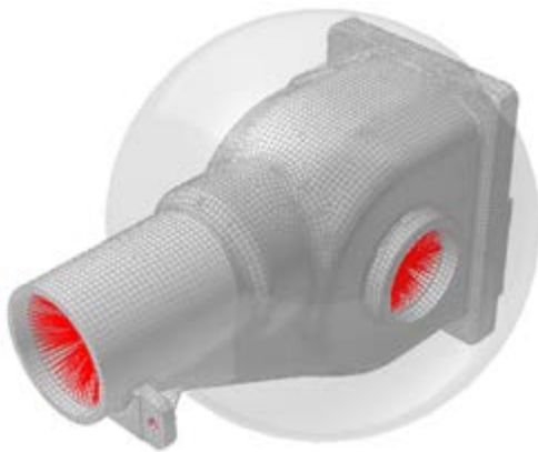
FIGURA 15 - RADIATORE SFERICO E HOUSING DELL'ASSALE ELETTRICO
