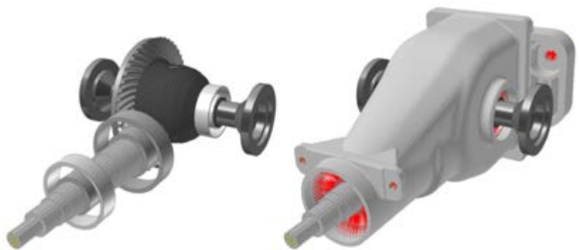
FIGURA 6 - MODELLO MULTIBODY DELL'ASSE ELETTRICO DEL CASO DI STUDIO
